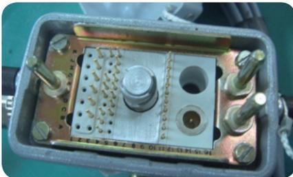
모듈 형 콘넥터 시스템과 높은 전원, 신호, 동축 및 광섬유 연락처, 압축 공기를 넣은 모듈 타입으로 높은 접촉 신뢰성과 낮은 저항, 고전류에도 유용 (10만회 이상의 Mating cycles)
