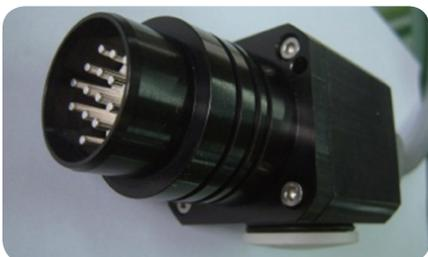
검사 라인의 자동 도킹형 콘넥터를 구성한 하네스 제품으로 주로 자동차 공장 또는 제품 테스트 지그를 구성하는 부분에 적용됨
